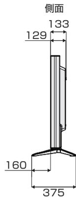
壁掛け金具取り付け部の寸法
